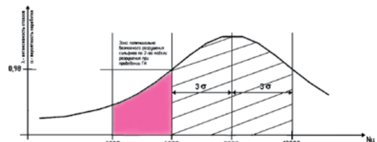
Рис. 7. Распределение наработок до полного разрушения 6-слойных сиффонов, изготовленных по ГОСТ Р 55019-2012, удовлетворяющее требованию 40 опрессовок
