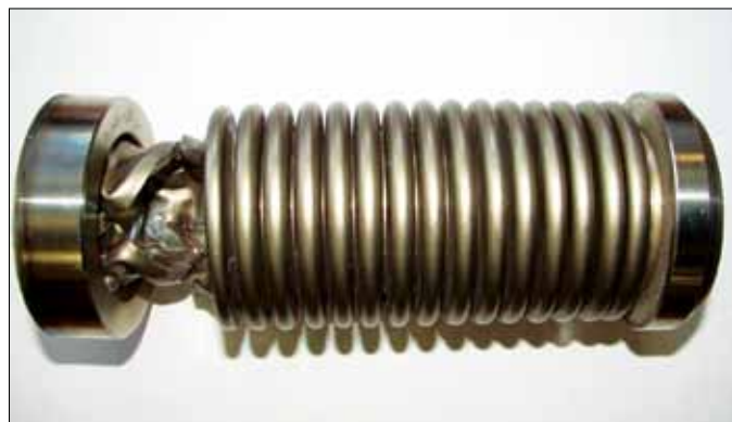
Рис. 4. Сильфон, разрушенный по модели 2 (нетиповая)
